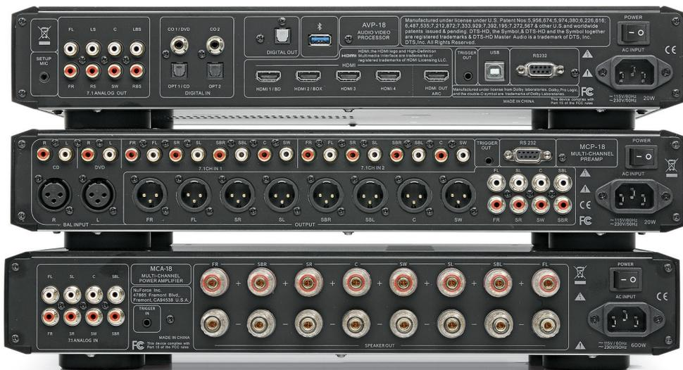
Процессор AVP-18 (вверху) оснащен только цифровыми входами, а предусилитель МСП-18 — только аналоговыми (конкретно — двумя линейными входами несимметричного сигнала, как стереофонического, так и многоканального, одним балансным стереовходом, а также несимметричным и балансным 7.1-выходом). Мощник МСА-18 (внизу) имеет несимметричный 7.1-вход и 8 пар акустических клемм.
